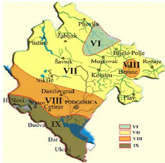
Slika 2.5. Karta seizmičke regionalizacije teritorije Crne Gore (V. Radulović, B. Glavatović, M. Arsovski i V. Mihailov, 1982)
