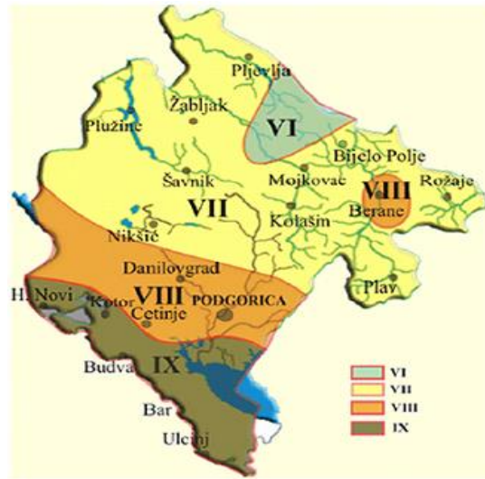
Slika 2.5. Karta seizmičke regionalizacije teritorije Crne Gore (V. Radulović, B. Glavatović, M. Arsović i V. Mihailov, 1982)
